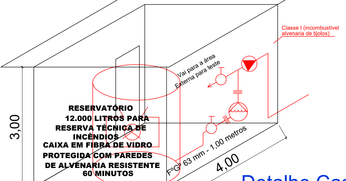
Detalhe Casa de Bombas SEM ESCALA
