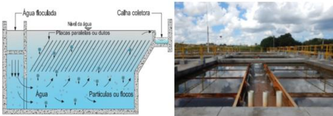
Figura 119-Decantadores da ETA Queima-Pé
