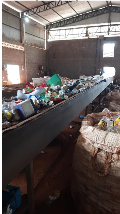
Figura 35-Esteira da Coopertan para processo de triagem.
