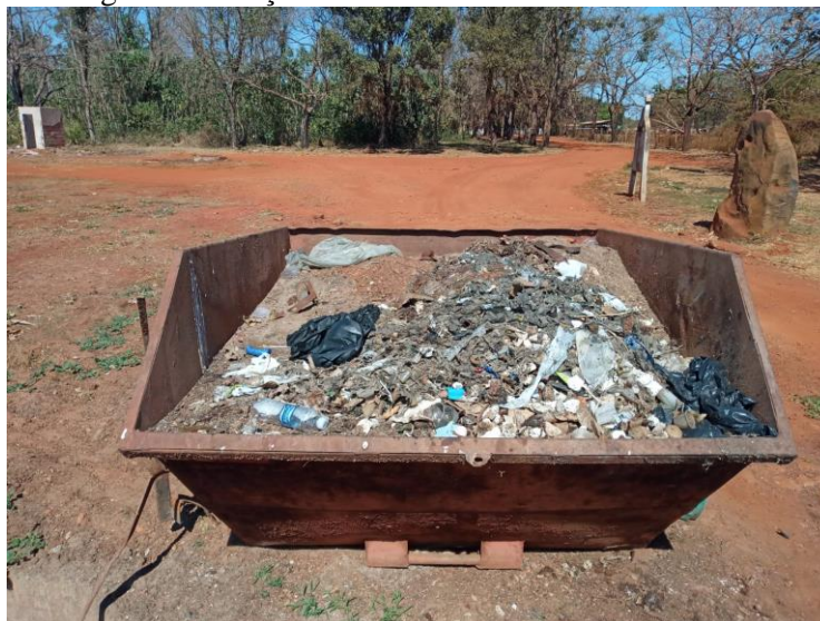
Figura 132-Caçamba estacionária metálica.
